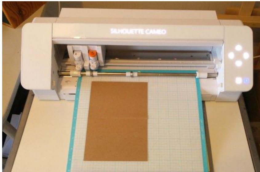
De mat wordt aan de voorkant in de plotter geladen. Op de mat zit het karton geplakt. Linksboven zie je twee mesjes naast elkaar.
